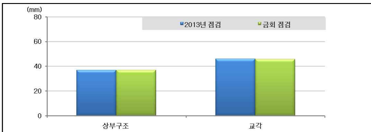
【그림 4.4】 부재별 탄산화깊이에 의한 콘크리트 잔여피복두께 비교
